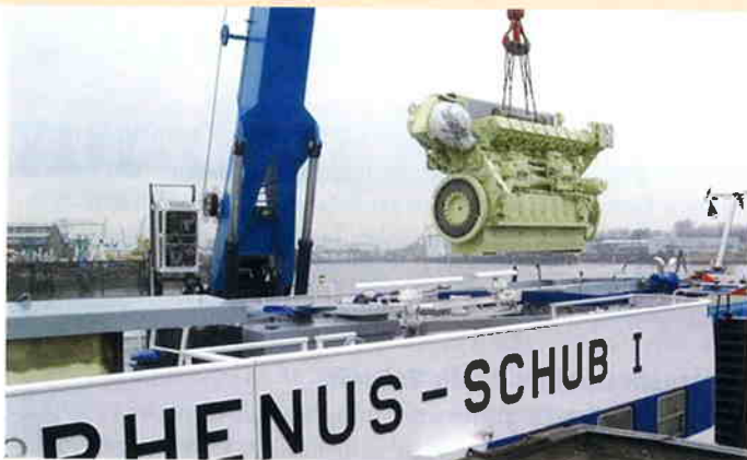
Der Liebherr-Bordkran des MS TRANSFERIUM hebt einen generalüberholten DEUTZ/Wärtsilä D628 an Bord des Rhenus-Schubers, der nun die Feinstaub-Grenzwerte nach ZKR-2 um 30 % unterschreitet | Bild: Wärtsilä
